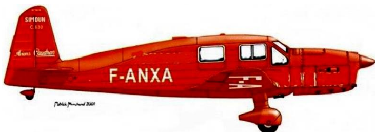
Caudron-Simoun conçu en 1934 : Long. 8,70 m / enverg. 10,40 m / Ht. 2,25 m / maxi 310 km/h
